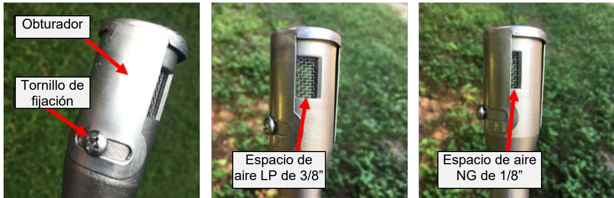
Ilustración 28 Regular el espacio de aire
