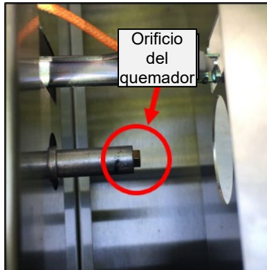
Ilustración 25 Prueba de detección de filtraciones en el orificio del quemador
