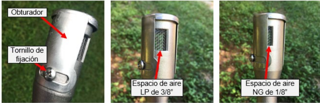
Ilustración 32 Regular el espacio de aire para la fuente de gas
