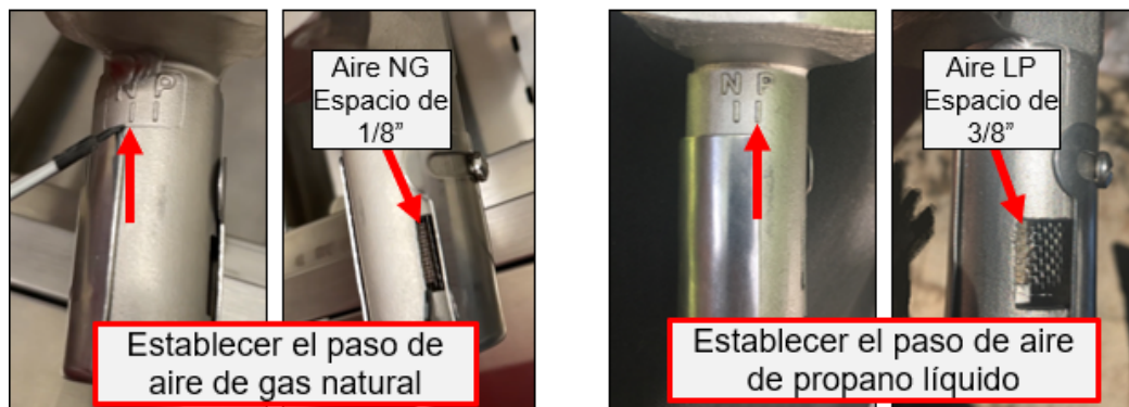
Ilustración 42 Regular el espacio de aire para la fuente de gas
