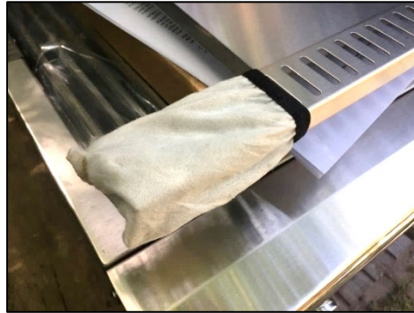
Ilustración 15 Protectores de la bandeja de goteo
