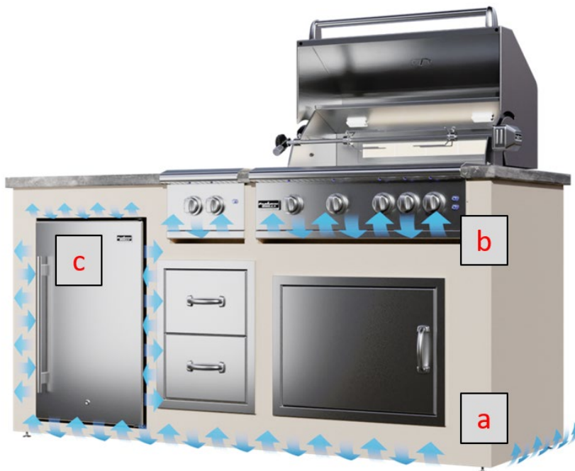
Ilustración 4 Ejemplo de ventilación en isla Paradise Grills
