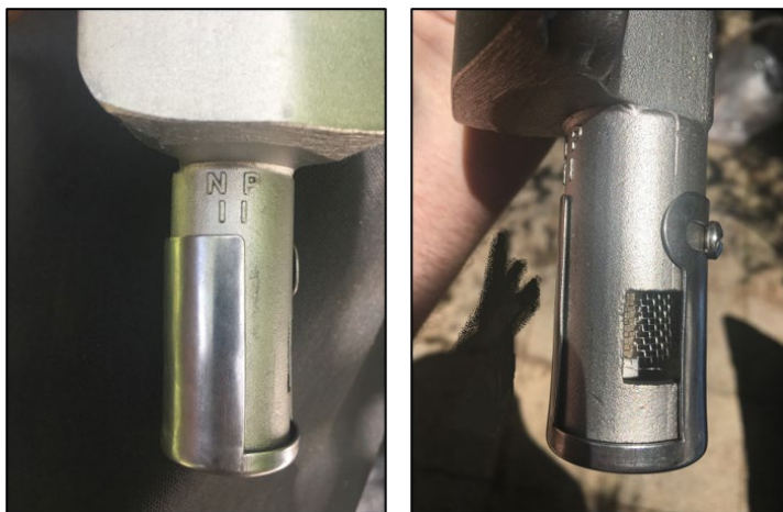
Ilustración 10 Espacio de aire del quemador
