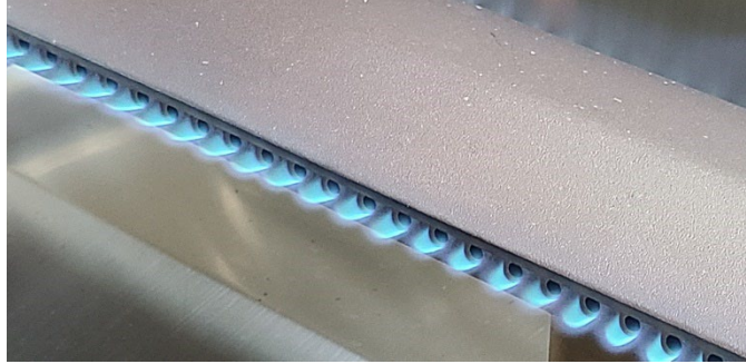
Ilustración 36 Apariencia correcta de la llama
